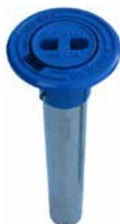
Sääd.venttiilihattu ø 200 h=120 väri sininen + kansi ø 115 mm D400 tiivisteellä + RST-putki ø 90 mm h=600
