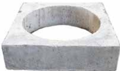
Betoninen korotuskehys ulkomitta 750 x 750 mm aukko ø 600 mm h=200 mm
