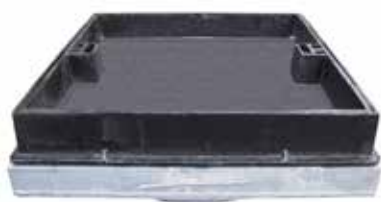
Kehys 725 x 725 h=105 Kansi 670 x 670 C250 Galvanoitu sovite-osa
