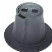
Venttiilihattu ø 270 h=170 + kansi ø 115 mm D400
