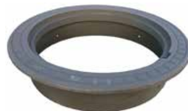
Säädettävä kehys Ø 500 h=135 LAIPAN HALKAISIJA Ø 640 mm Sopii betonoitavalle alueelle
