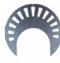
Sadevesikansi ø 315 mm Epäkeskeinen reikä ø 170 mm Reikä avoin, nk. kuunsirppi
