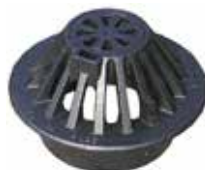
Säädettävä sadevesikupu ø 300 avattavalla puhdistusluukulla ø 180
