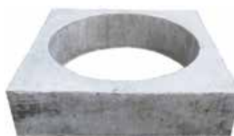
Betoninen korotuskehys ulkomitta 780 x 780 mm aukko \varnothing 640 mm h=200 mm
