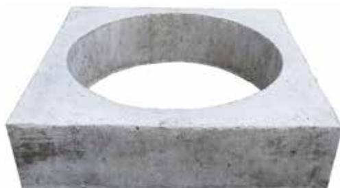
Betoninen korotuskehys ulkomitta 780 x 780 mm aukko ø 640 mm h=200 mm
