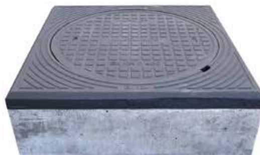
Sääd.kehys ø 640 h=270 mm / laippa nelikulmainen kansi 640D400 + betoninen korotuskehys
