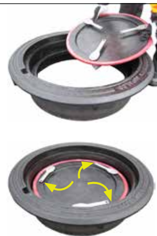
RST-kahvat käännetään kiinni- asentoon nuolien suuntaisesti.
