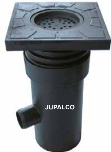
Kehys 430 x 430 + sadevesipotero \varnothing 250 + rumpuputki \varnothing 315 mm
