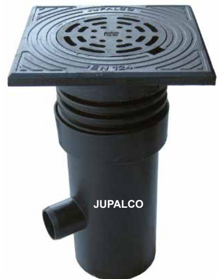
Sääd.kehys \varnothing 300 / laippa nelikulmainen + Sadevesikansi 300 C250 + rumpuputki \varnothing 315 mm
