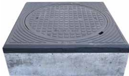
Sääd.kehys ø 640 h=270 mm / laippa nelikulmainen kansi 640D400 + betoninen korotuskehys
