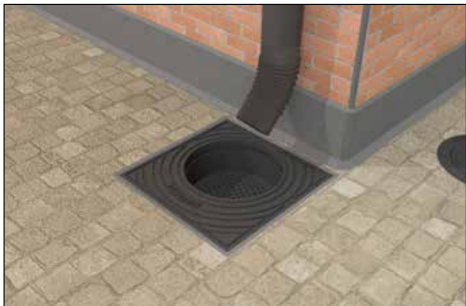
Valurautainen säädettävä kehys 480 x 480 mm Sadevesikansi 310 mm Muovinen rännikaivo Jupalco RK-315-SOK
