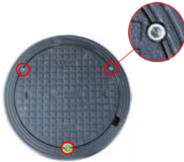
Sääd.kehys ø 600 + kansi ø 600D400 Lukittu kolmella kuusiokolopultilla
